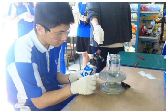
圖 3 利用噴燈將蒐集得來的玻璃瓶來進行切割，並戴上護目鏡保護眼睛
