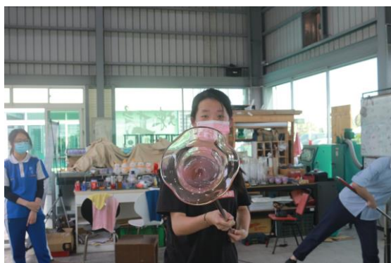
圖 10 透過甩桿技法，利用離心力讓玻璃成花邊曲面造型
